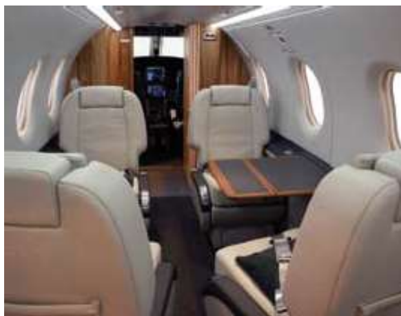
Innenverkleidung und Cockpit der PC-12 Flugzeuge wurden mit unserem Kontaktklebstoff ohne VOC verklebt.
