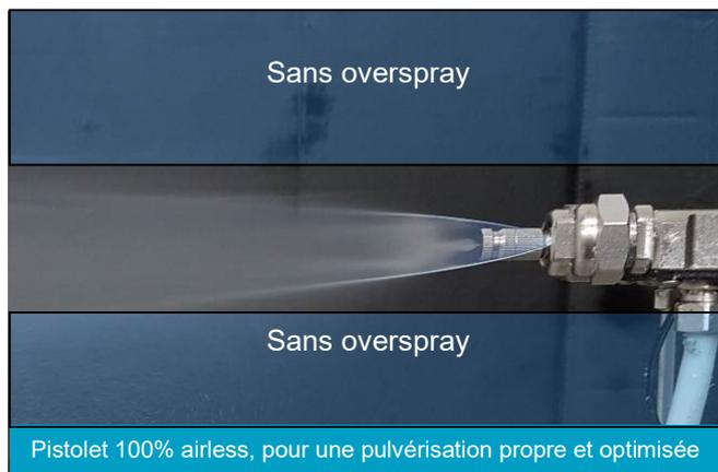
Pistolet 100% airless, pour une pulvérisation propre et optimisée
